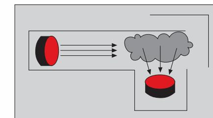
Dringt Brandrauch in die Rauchkammer ein, werden diese Lichtstrahlen gestreut und dadurch auf die Fotolinse abgelenkt. Der Rauchmelder erkennt Brandrauch und löst das Warnsignal aus. Das Gerät alarmiert solange, bis die Kammer wieder rauchfrei ist.
