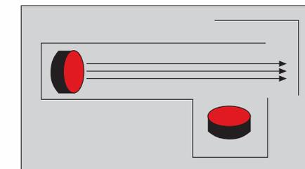
Im Inneren des Melders befindet sich eine Rauchkammer, in der regelmäßig Lichtstrahlen ausgesendet werden. Ist die Kammer rauchfrei, so treffen diese nicht auf die Fotolinse, da die Oberfläche der Rauchkammer kein Licht reflektiert.
