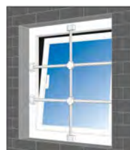
Montage auf dem Fensterrahmen
